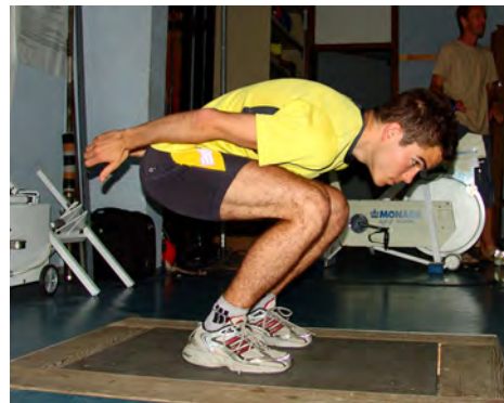
Smučarski skakalec Jernej Danjan pri testiranju odzivne moči na tenziometrijski plošči, 2005.
